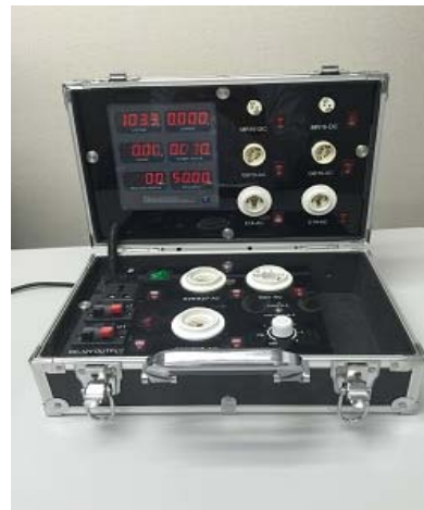
(写真④) 照明器具・電源検査装置
